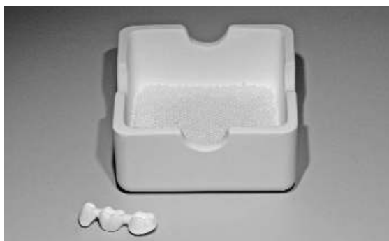
Лоток для обжига заполнен 100 г ZrO 2 -дробью
