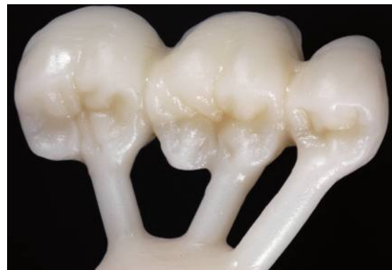
Черновая распаковка проводится стеклянной полировочной дробью под давлением 4 атм. (60 psi) до обнажения реставрации. Окончательная распаковка проводится под давлением 2 атм. (30 psi).
