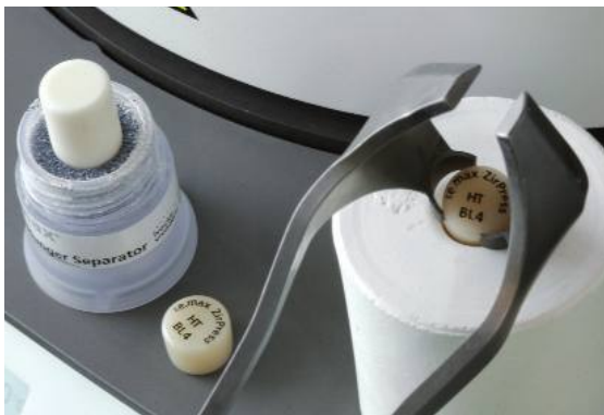
После окончания цикла прогрева опоки вставьте холодную заготовку в прогретую опоку и проведите прессование.
