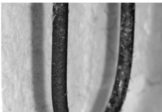
Загрязненный сильно корродированный нагревательный элемент
