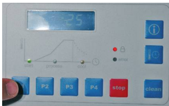
Нажмите P1. Программа спекания запускается автоматически, и дверца блокируется
