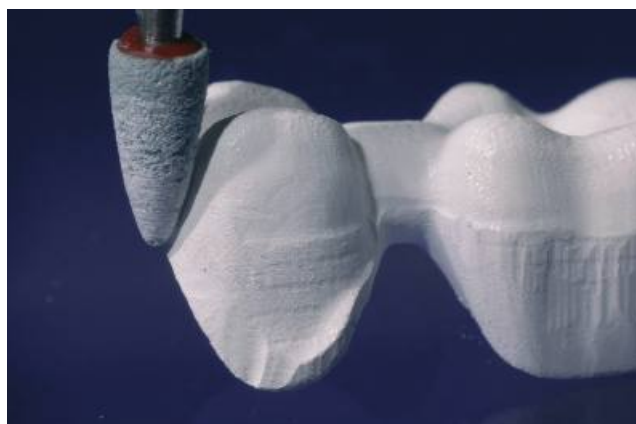
Используйте соответствующие абразивные инструменты для корректировки/финишной обработки неспеченного каркаса
