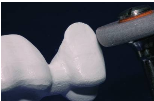
Загладьте откорректированные области, учитывая минимальную толщину каркаса
